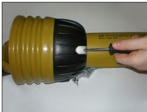
Introduceți șurubelnițele în cleme
