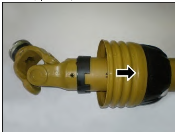
Glisați scutul înapoi pentru a descoperi articulația
