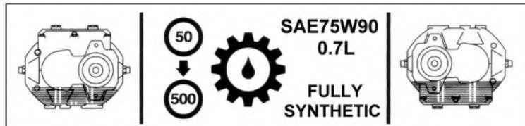
Abfließen lassen des Getriebeöls zum Wechseln ist durch die Ablassschraube am dem Getriebe möglich. Zum wieder Auffüllen oder Nachfüllen des Öls, entfernen Sie beide rechts gezeigten Pfropfen und füllen Sie das Getriebe durch den Füllpfropfen bis das Öl anfängt aus der Füllstandöffnung zu laufen. Setzen Sie die Pfropfen wieder fest und sicher ein.
