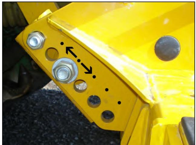
**WICHTIG:** Rückseite der Ausgleichszunge sollte so nahe sein, wie möglich zur Unterseite des Ausgleicherschlitzes mit der Maschine im Ruhezustand aus den Grund. Iif erforderliche Änderung die Befestigungspunkte des Ausgleichers niedriger und/oder das Gabelkopfzubehör bringen in Position, um diese Einstellung zu erzielen.
