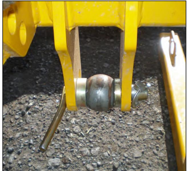
Passende unterere Verbindung Kugeln und Distanzscheiben in untereren Rahmen und sichern mit Sicherungsstiften – *Gebrauchdistanzscheiben für beste Ausrichtung mit Traktorgestänge.*
