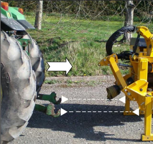
Fahren Sie den Traktor rückwärts an die Maschine heran.
