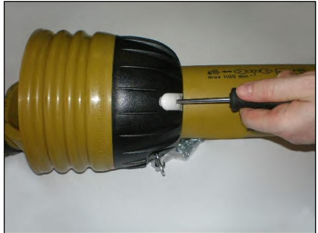
Schieben Sie Schraubenzieher in die Klappen
