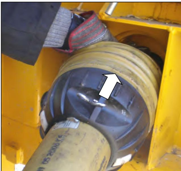
Passende Getriebewelle zum Maschinen Getriebe.
