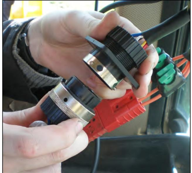
Schließen Sie an Steuereinheit im Traktorfahrerhaus an.
