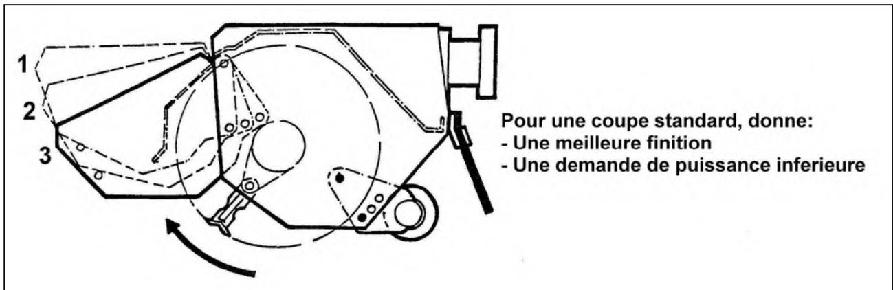
Le capot avant et les volets arrière doivent toujours être en place.
