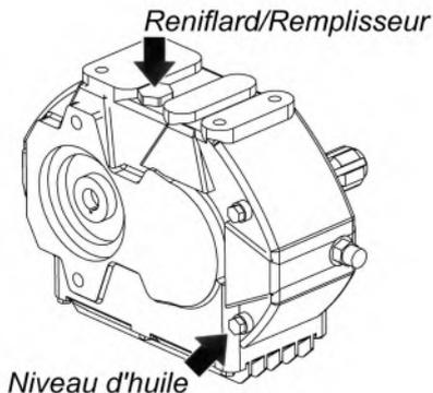
Le drainage de la boîte de vitesse pour un changement d'huile est par l'intermédiaire du bouchon de vidange situé sur la base de la boîte de vitesse.
