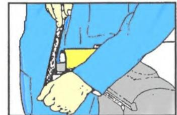
NOTA: Pour l'usage avec tracteurs différent l'arbre devrait être mesuré encore pour vérifier l'adéquation- *il faut qu'il y a un chevauchement d'arbre de 150mm (6").*
