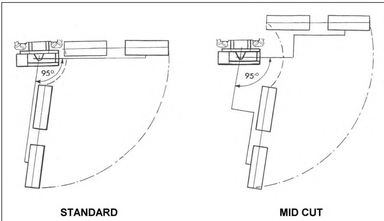
Le dispositif de pivot hydraulique permet un arc de 95° arc du mouvement actionné de bras de la cote travaillant de la position perpendiculairement au tracteur à l'arrière à 5° au delà de la ligne directe à l'arrière.
