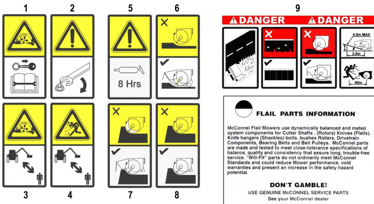
1. **Attention !** Lames rotatives ; rester à distance de la machine, arrêter la machine (attendre l'arrêt du rotor), retirer la clé du véhicule et lire le manuel avant d'effectuer tout travail de réparation ou de maintenance.
