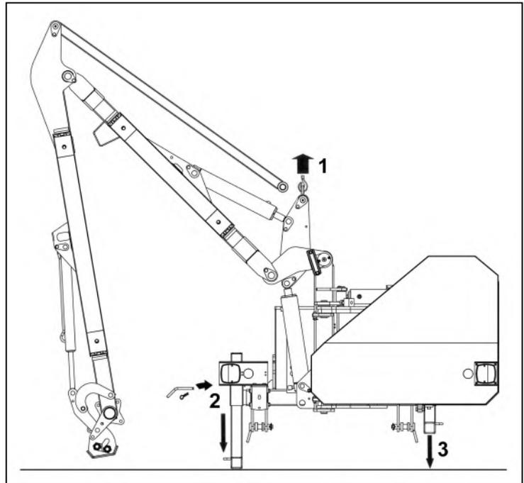
Abaissez les jambes et la goupille en position choisissant les trous qui placent usine le demi-arbre de boîte de vitesse approximativement. 75mm au-dessous de l'axe des tracteurs PTO - notez la goupille position de jambe utilisée.
