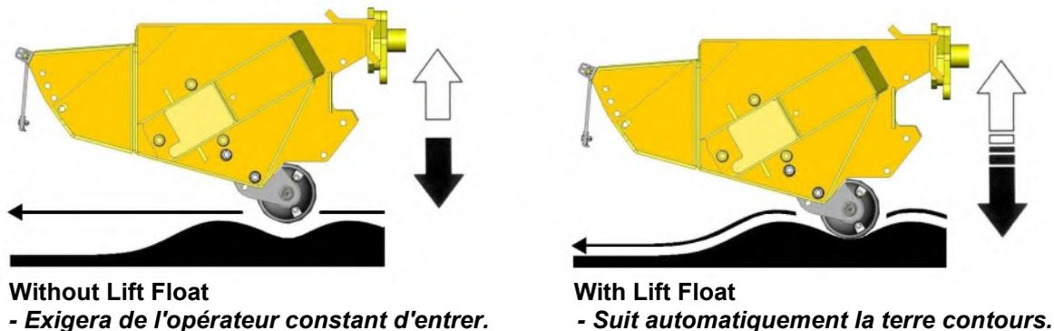
Pour les kits flottaisons qui sont montées dans l'usine l'activation est à partir des commandes dans la cabine. (Lisez les pages sur les contrôles pour plus d'info).
