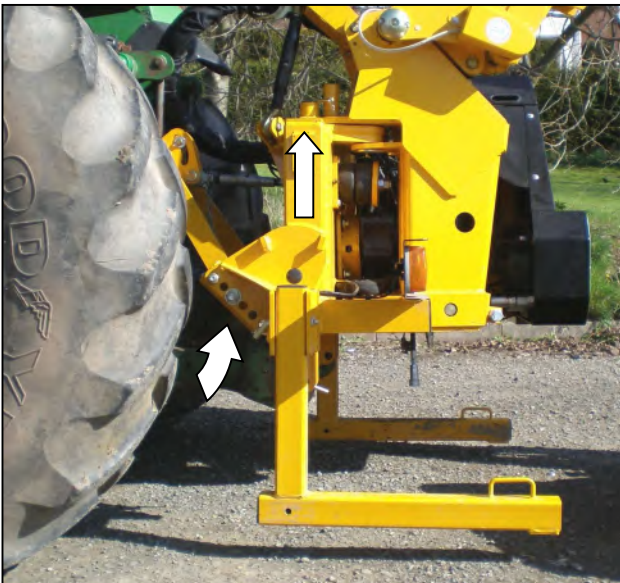
Pas tractor stabilisatoren en tractor koppeling te verhogen om de machine op te heffen om de werkhoopte.
