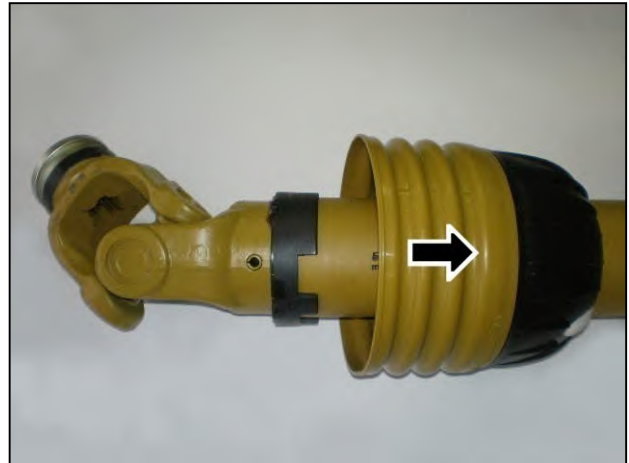
Schuif het scherm terug zodat de kruiskoppeling vrij komt
