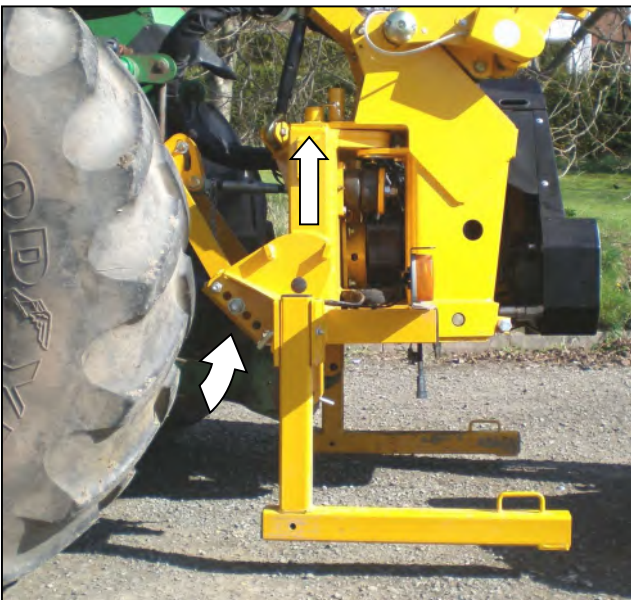
Zategnite stabilizatore traktora - podignite polugu traktora kako biste podigli stroj na radnu visinu.
