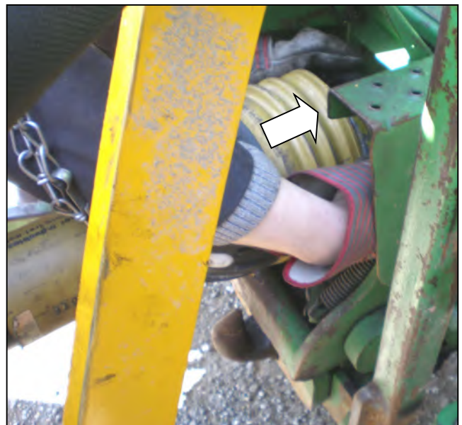
Pričvrstite zglobno vratilo na izlazno vratilo traktora.
