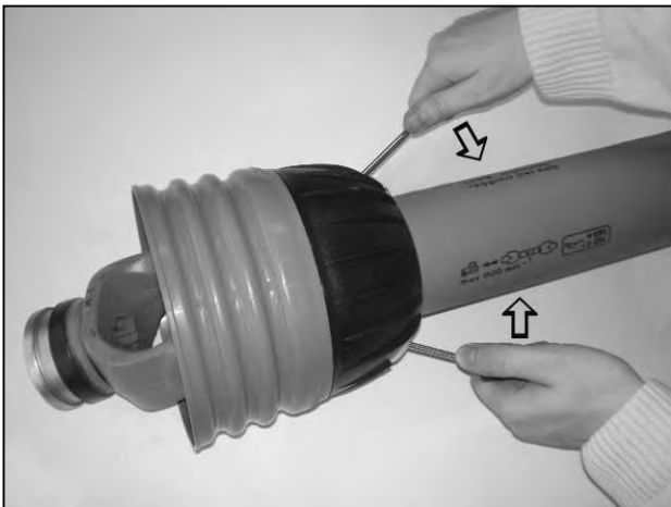
Otvorite stezaljke kako biste otpustili oklop.
