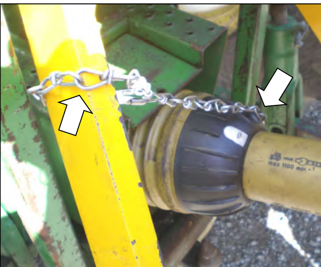
Pričvrstite lance zakretnog momenta na prikladna mjesta kako biste spriječili okretanje štitnika zglobnog vratila.
