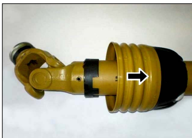
Сдвинуть кожух назад для открывания карданного соединения
