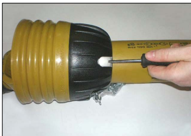
Вставить отвертки в фиксаторы
