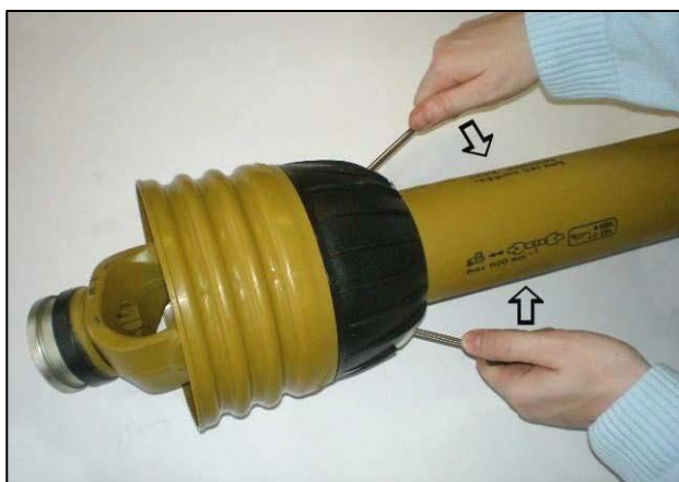
Сместить фиксаторы для снятия кожуха
