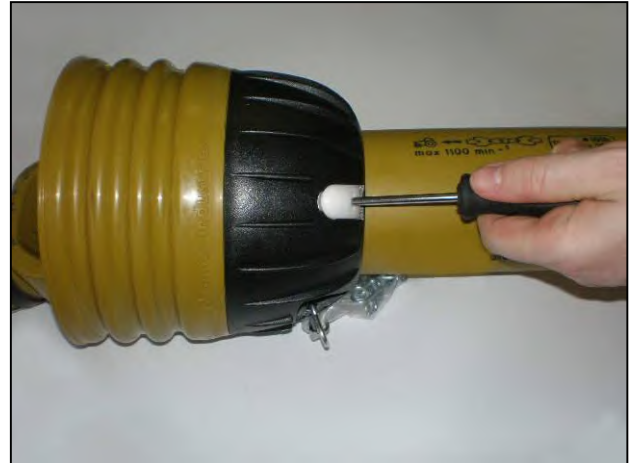
Schieben Sie Schraubenzieher in die Klappen
