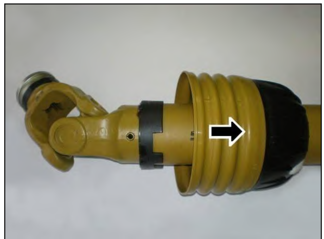
Ziehen Sie den Schutz zurück, um das Gelenk freizulegen
