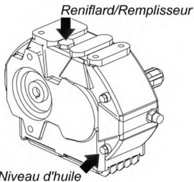
Le drainage de la boîte de vitesse pour un changement d'huile est par l'intermédiaire du bouchon de vidange situé sur la base de la boîte de vitesse.
