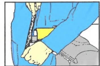
NOTA: Pour l'usage avec tracteurs différent l'arbre devrait être mesuré encore pour vérifier l'adéquation- il faut qu'il y a un chevauchement d'arbre de 150mm (6").
