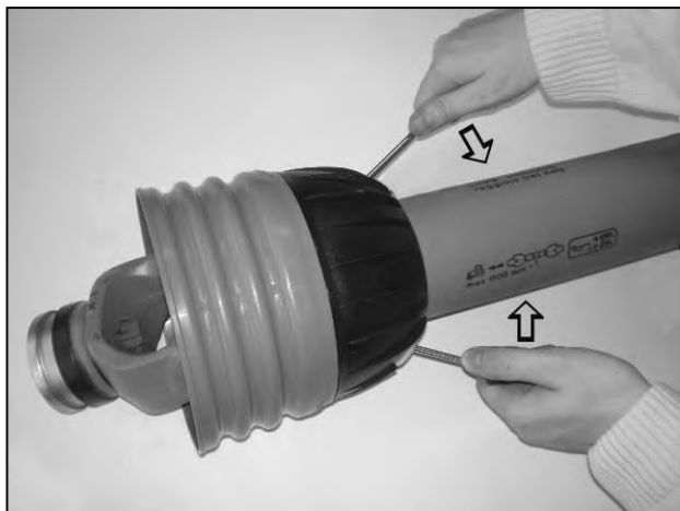
Ouvrez les fermoirs pour dégager la protection
