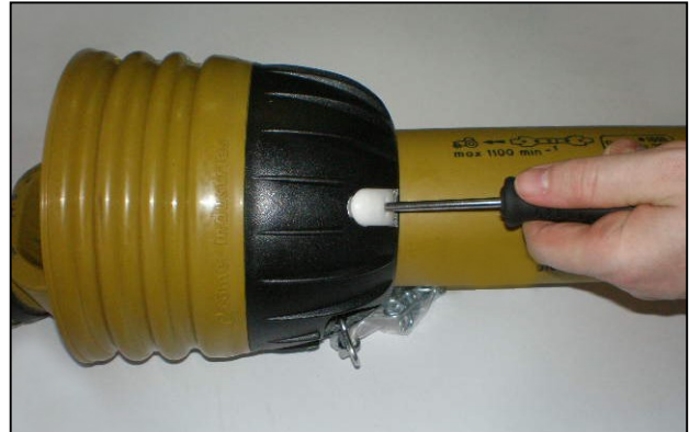
Schieben Sie Schraubenzieher in die Klappen
