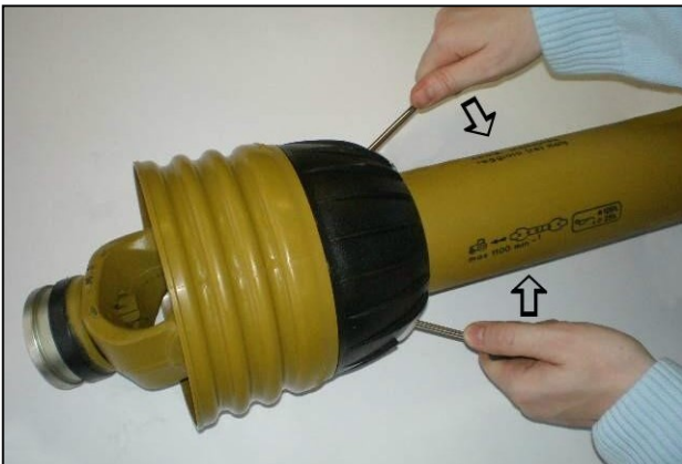
Klappen hochwuchten um den Schutz zu lösen
