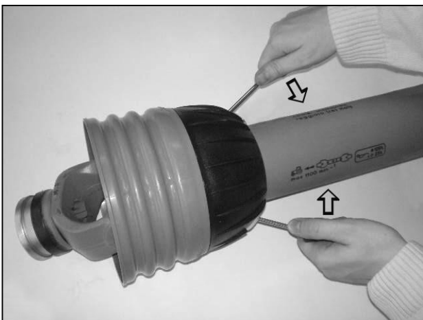
Ouvrez les fermoirs pour dégager la protection
