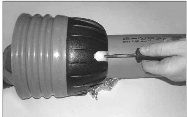
Insérez les tournevis dans les fermoirs
