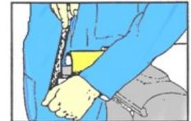
**HINWEIS:** Zur anschließenden Verwendung an verschiedenen Traktoren, muss die Welle erneut ausgemessen und auf Eignung geprüft werden – Die minimale Schaftüberlappung muss 150mm betragen.
