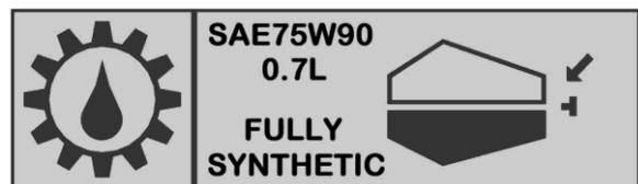
Abfließen lassen des Getriebeöls zum Wechseln ist durch die Ablassschraube am dem Getriebe möglich. Zum wieder Auffüllen oder Nachfüllen des Öls, entfernen Sie beide rechts gezeigten Pfropfen und füllen Sie das Getriebe durch den Füllpfropfen bis das Öl anfängt aus der Füllstandöffnung zu laufen– Setzen Sie die Pfropfen wieder fest und sicher ein.
