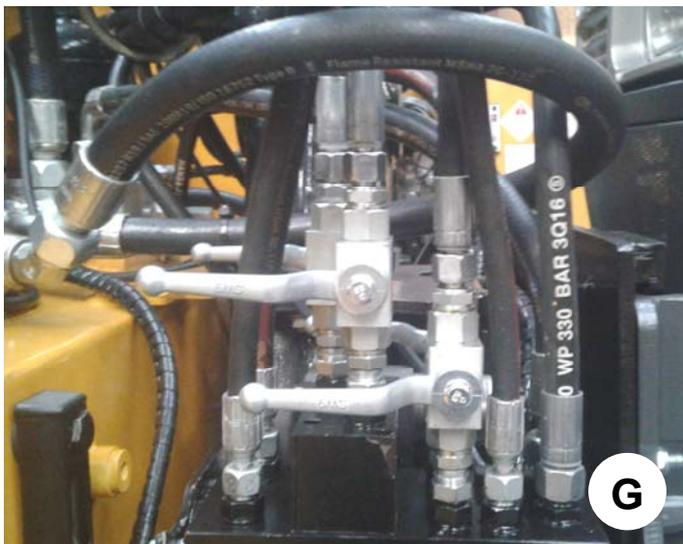
**G.** In Transport Stellung die Kugelhähne am Ventilen Blok Zu drehen.
