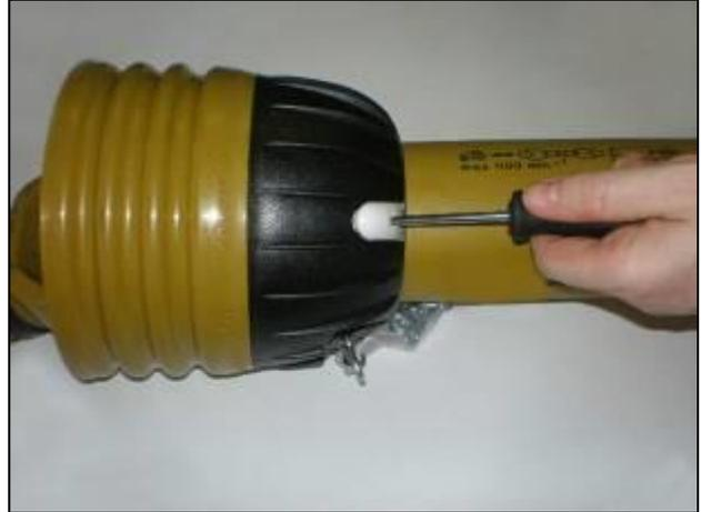
Schieben Sie Schraubenzieher in die Klappen
