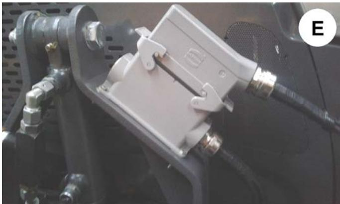
**E.** Montieren sie den Harting Stecker am Schlepper.
