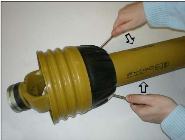
Druk de klemmen open om het scherm te ontgrendelen
