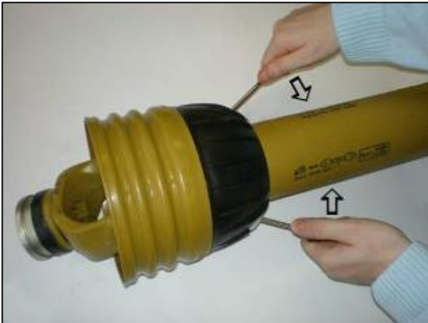
Klappen hochwuchten um den Schutz zu lösen
