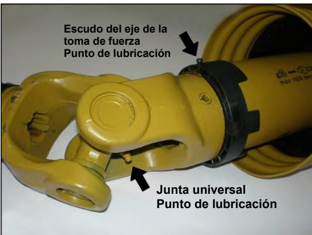
Ubicación de los puntos de lubricación
