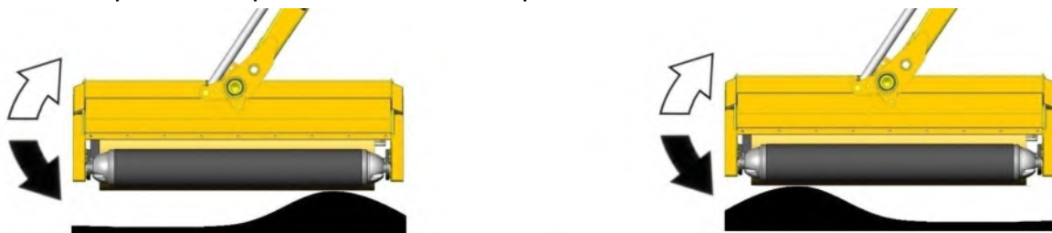
Flotador de ángulo apagado – Requiere la intervención del operador para ajustar el ángulo del cabezal de mayales.
