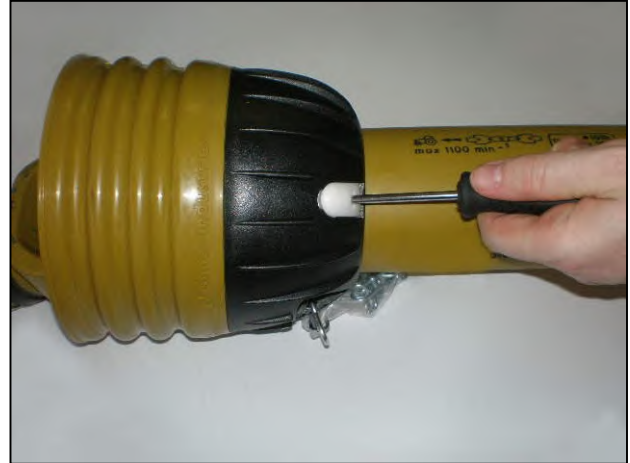
Inserte los destornilladores en los cierres
