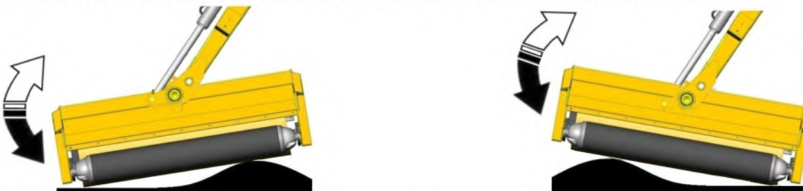
Flotador de ángulo encendido – El cabezal de mayales se orienta automáticamente para coincidir con los contornos del terreno.
