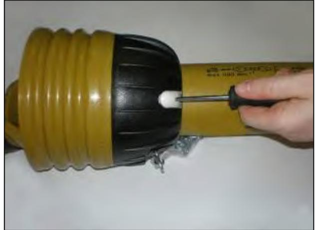
Schieben Sie Schraubenzieher in die Klappen
