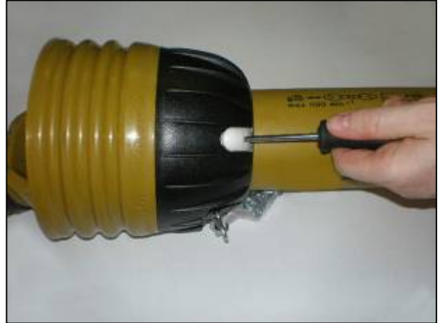
Schieben Sie Schraubenzieher in die Klappen
