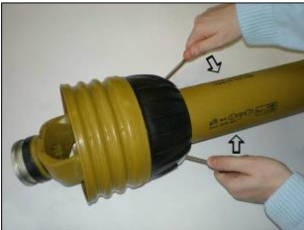
Klappen hochwuchten um den Schutz zu lösen
