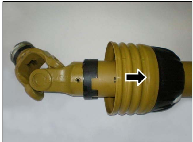
Deslice el escudo hacia atrás para dejar al descubierto la junta universal
