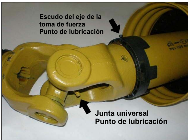
Ubicación de los puntos de lubricación
