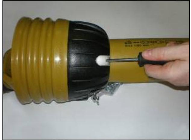
Schieben Sie Schraubenzieher in die Klappen
