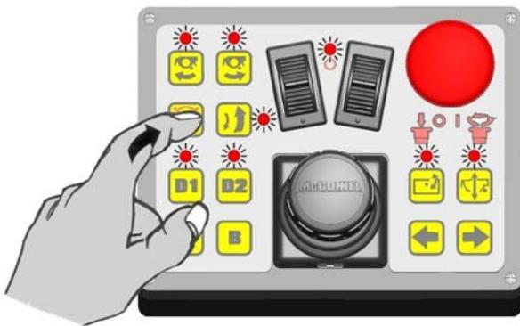
Drücken Rotor Aus-Taste, um die Kalibrierungs-Modus zu gelangen; alle LEDs gleichzeitig blinken einmal zu bestätigen.
