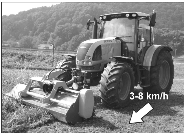
Vitesse de travail optimale vers l'avant 3-8 km/h
