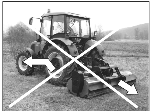
Soulevez la machine avant de tourner ou de reculer
