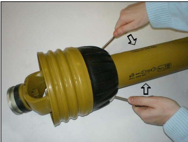
Klappen hochwuchten um den Schutz zu lösen
