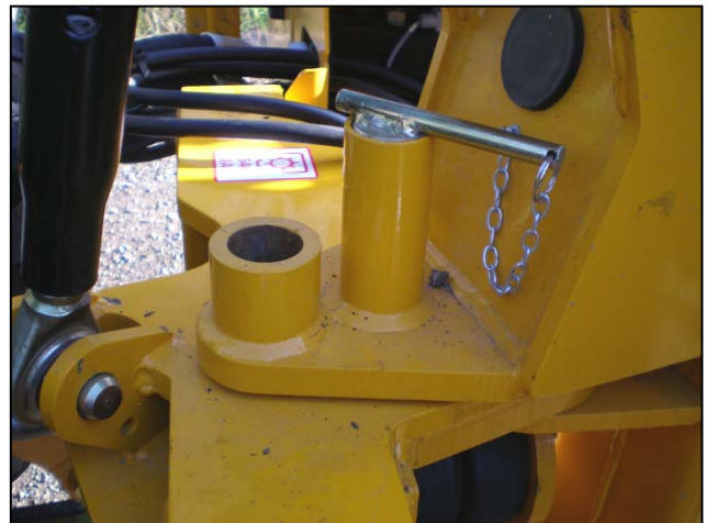
Schwenken entsperrt – nur zum Arbeiten
