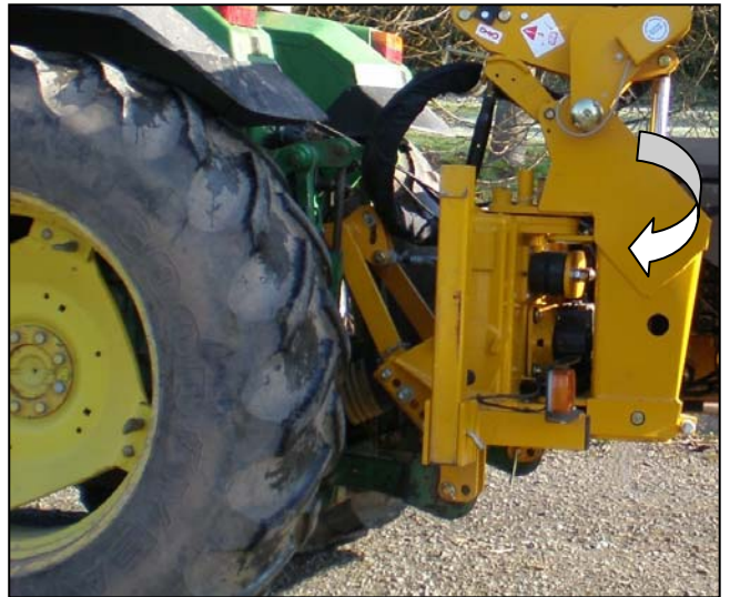
Öffnen Sie den Hubkolbenhahn – schwenken Sie die Maschine auf die Arbeitsseite des Traktors
