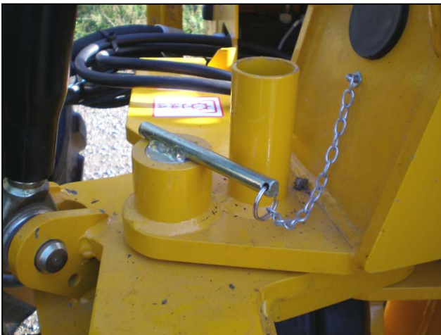
Schwenken gesperrt – immer für Transport und Lagerung
