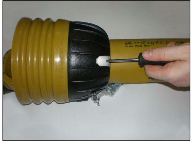
Schieben Sie Schraubenzieher in die Klappen
