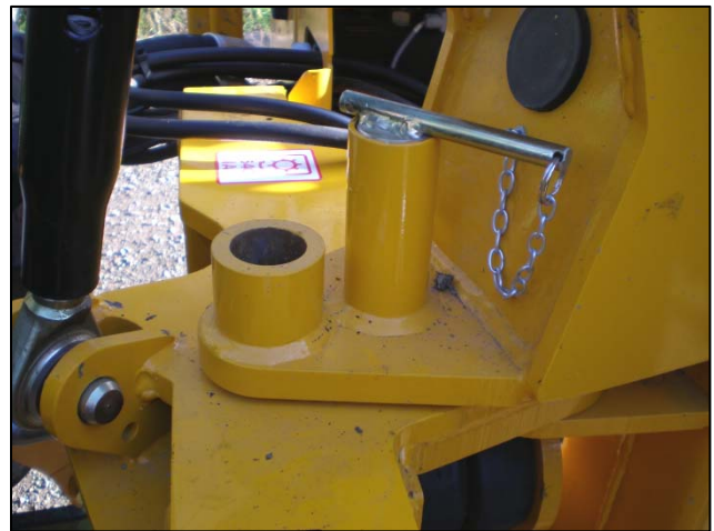
Schwenken entsperrt – nur zum Arbeiten
