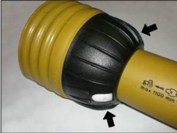
Gleitlagerring des Schutzes
