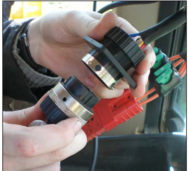
Schließen Sie an Steuereinheit im Traktorfahrerhaus an.
