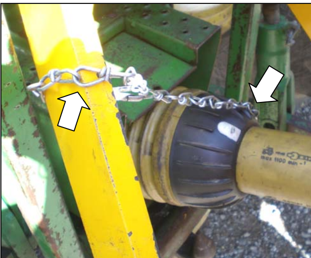
Befestigung Ketten, zum des Getriebewelleschutzes vom Drehen zu stoppen.
