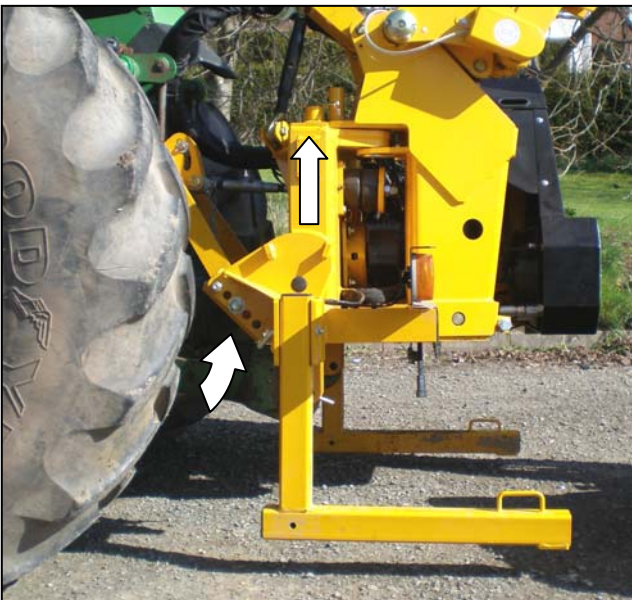
Ziehen Sie Traktorausgleicher fest - heben Sie Traktorgestänge an, um die Maschine zu seiner Arbeitshöhe anzuheben.
