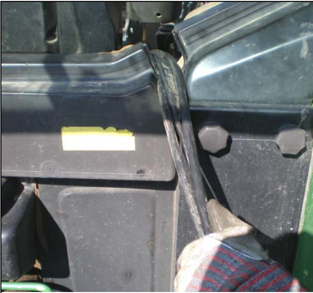
Zufuhrsteuerlinien in Traktorfahrerhaus – vermeiden scharfe Schlaufen und halten Linien wohles freies von allen beweglichen Teilen auf der Maschine oder dem Traktor.
