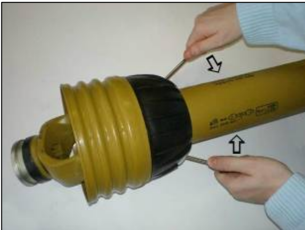
Klappen hochwuchten um den Schutz zu lösen
