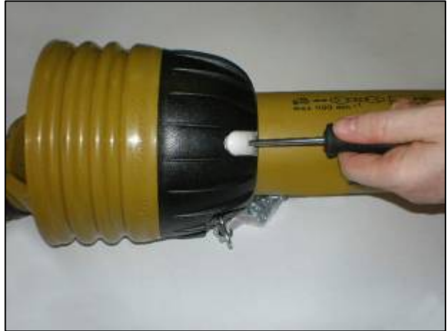
Schieben Sie Schraubenzieher in die Klappen
