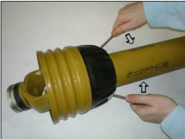
Klappen hochwuchten um den Schutz zu lösen
