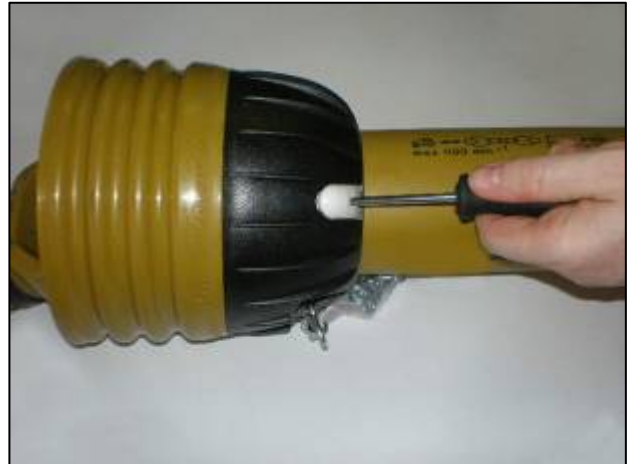
Schieben Sie Schraubenzieher in die Klappen
