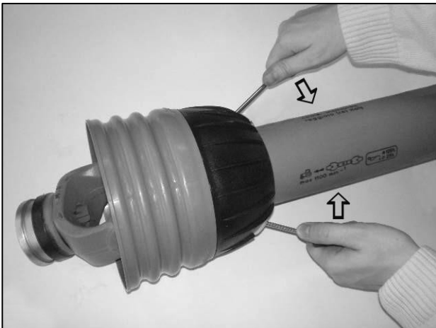
Ouvrez les fermeurs pour dégager la protection
