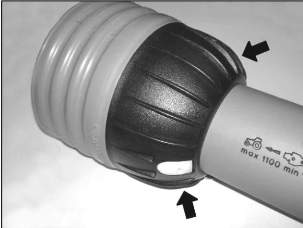
Fermeurs de la protection d'axe
