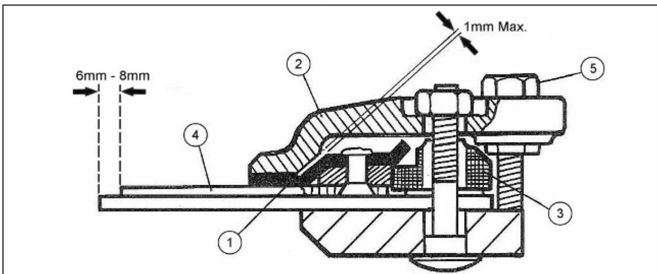
Bei richtiger Einstellung liegen die Messerabschnitte (4) bündig zwischen den Zinken und der unteren Fläche des Messerhalters (1), wobei die Zinken etwa 6 bis 8 mm vor den Messerspitzen liegen sollten. Der Spielraum zwischen den geneigten Flächen des Messerhalters (1) und der Führungsleiste (2) darf max. einen Wert von 1 mm haben. Dieser Spielraum erlaubt die freie Beweglichkeit der Messer.
