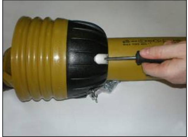
Schieben Sie Schraubenzieher in die Klappen
