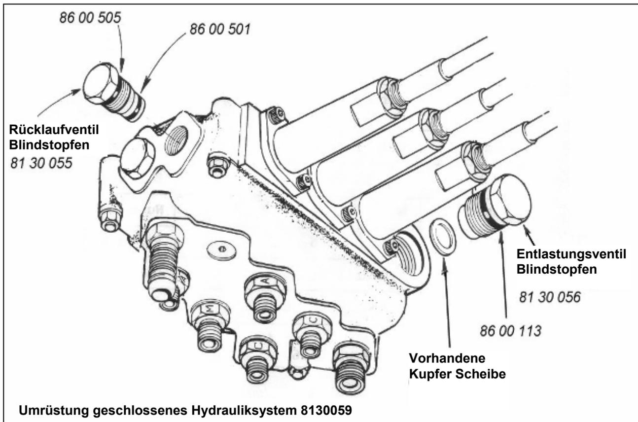
Eine Steuerungsventil- Umrüstungsausstattung (Art. Nr. 8130059) besteht aus einem Entlastungsventil Blindstopfen, welcher in das vorhandene Entlastungsventil und Rücklaufventil Blindstopfen gesetzt wird, welcher anstelle von dem Standard Adapter an dem Ventilausgang neben der Hubkreislaufverbindung sitzt.
