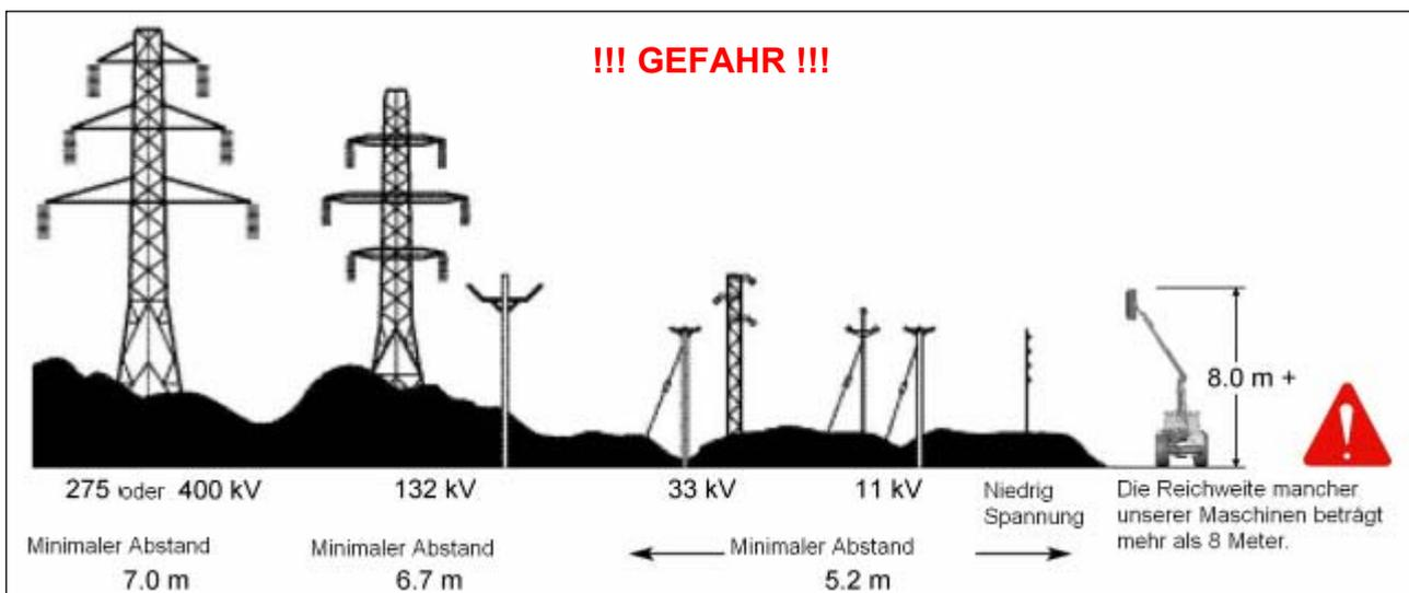
Es kann nicht genug betont werden, wie gefährlich das Arbeiten in der Nähe von Hochspannungsleitungen ist. Manche unserer Maschinen sind in der Lage mehr als 8 m Höhe zu erreichen und somit die gesetzlich minimale Höhe von 5,2 m der 11 Volt und 33 Volt- Hochspannungsleitungen bis zu 3 Meter zu überschreiten.
