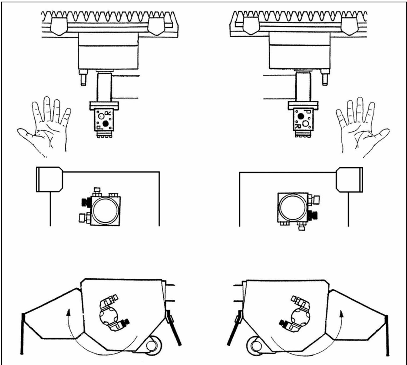
Wenn die Maschine angebaut ist, bedienen Sie die Maschine in ihrer vollen Beweglichkeit, um zu Prüfen, dass die Schläuche nicht spannen, klemmen, reiben oder knicken und stellen Sie sicher, dass alle Bewegungen richtig funktionieren.
