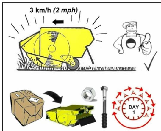
**Ersten Einsatztag- stündlich Spannung der Muttern und Schrauben prüfen.**
