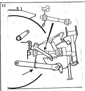
Montez l'arbre de transmission et attachez la chaîne de couple à un endroit approprié de sorte à éviter la rotation du carter de l'arbre.
