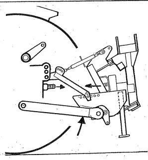
Soulever la machine à l'aide du relevage trois points à la hauteur de travail, c'est à dire jusqu'à ce que l'arbre de prise de force et l'arbre d'entrée du boîtier soient autant que possible en ligne droite.
