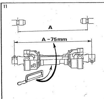
Mesurez "A" Coupez deux longueurs identiques de l'arbre de transmission de sorte que "A" mesure -75 mm (fermeture complète).
