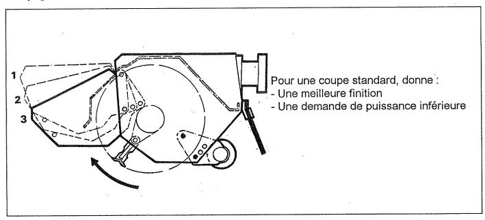
Le capot avant et les volets arrières doivent toujours être en place.
