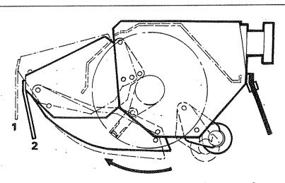
Un capot avec ou sans volet et un volet arrière doivent être montés. Les trous permettent deux positions de montage du capot avant et des patins. Toutes les combinaisons de montage sont possible.
