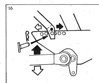
Réglez "A" avec précision. Utilisez le trou de montage permettant l'alignement de l'arbre de transmission avec le groupe motopropulseur.
