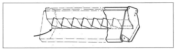
Chaque hotte de broyage est équipée sur le dessous d'un dispositif pour découper le fil de fer. Cette tôle ne doit en aucun cas toucher le rotor.
